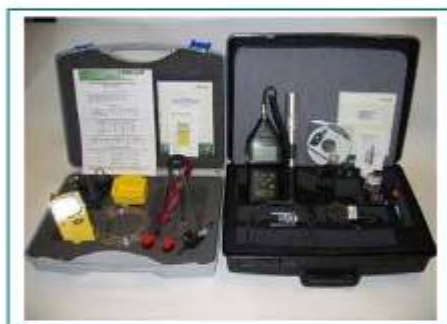
Слика бр. 1: Инструмент за мерење на фракција ЦЧ10 на суспендирани цврсти честички
